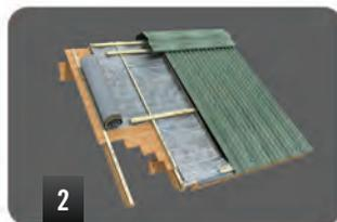
2 Continúe la colocación de la membrana ISOLANT®, uniéndola con el tramo anterior mediante el solape autoadhesivo Rapi-Tac®. Luego repita los pasos 1 y 2. Cubra la totalidad del techo, y por último coloque las tejas o chapas.
